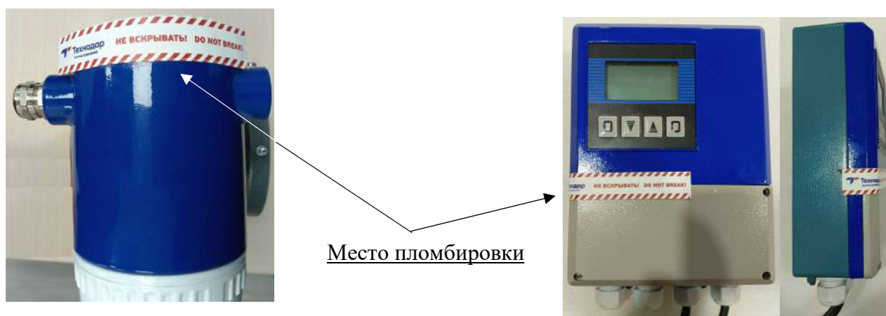
Рисунок 4 – Схема пломбировки от несанкционированного доступа расходомеров электромагнитных Sekee EM
