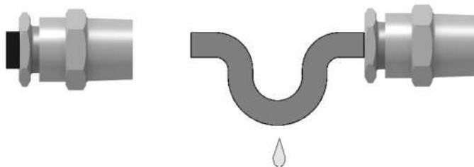
U-образная петля для исключения попадания жидкости в электронный блок при стекании ее по кабелю
