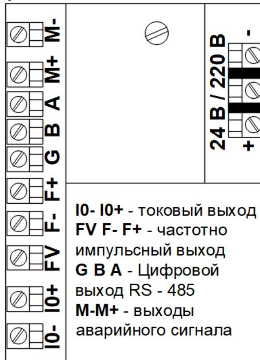
Рисунок 5 - Общий вид и назначение выходных разъемов расходомера
