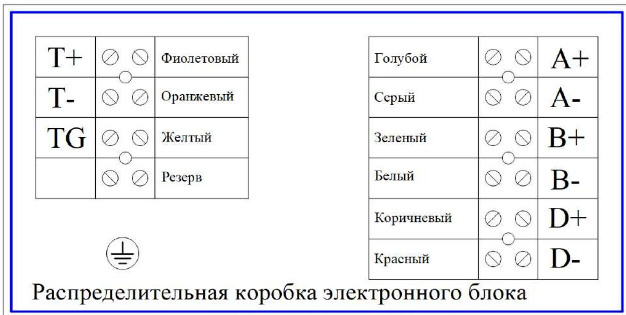
Рисунок 8 - Внешний вид распределительной коробки электронного блока
